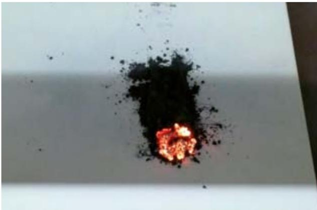
Bild 10-15: Bestimmung der Brennzahl bei Stäuben nach VDI 2263
