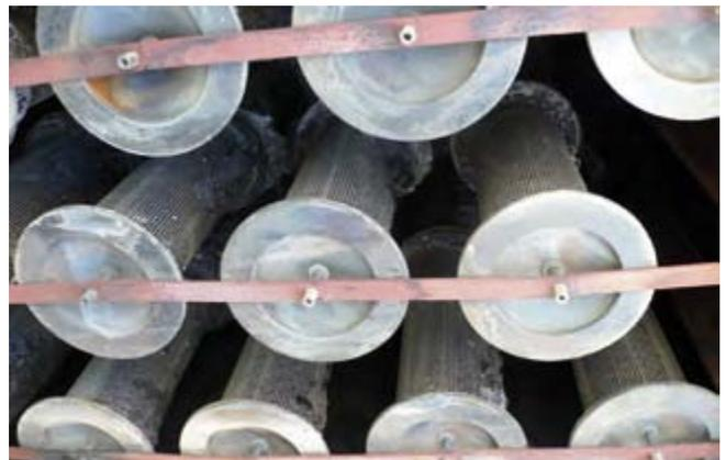
Bild 10-16: Zerstörte Filterelemente
