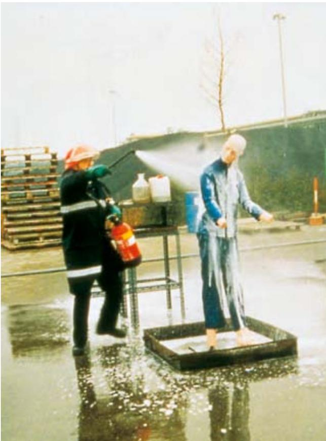
Bild 11-35: Ablöschen brennender Kleidung mit einem Feuerlöscher
