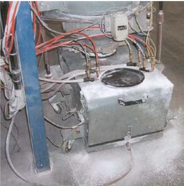
Bild 10-5: Pulverablagerungen an einer elektrostatischen Pulversprühanlage
